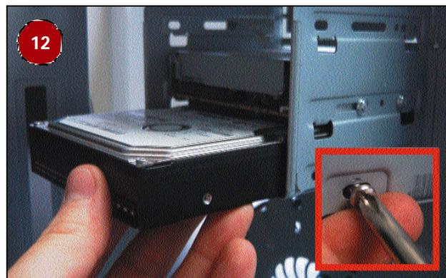
los discos será maestro y cuál esclavo. Si sólo vamos a colocar un disco, como es nuestro caso, este punto no tendrá que preocuparnos, ya que los discos vienen, por defecto, configurados como maestro. Respecto a los tornillos, y salvo algún modelo de disco muy concreto, aquí tendremos que utilizar los de rosca gorda si queremos sujetarlo convenientemente. Igualmente, no podemos utilizar alguno demasiado largo, ya que podríamos dañar el disco internamente.
