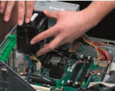
↑ Reemplazo del sistema de refrigeración. Medida de mantenimiento correctivo.
